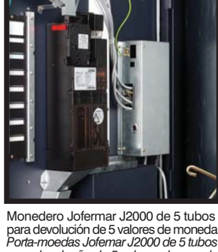
Monedero Jofemar J2000 de 5 tubos para devolución de 5 valores de moneda Porta-moedas Jofemar J2000 de 5 tubos para devolución de 5 valores de moneda
